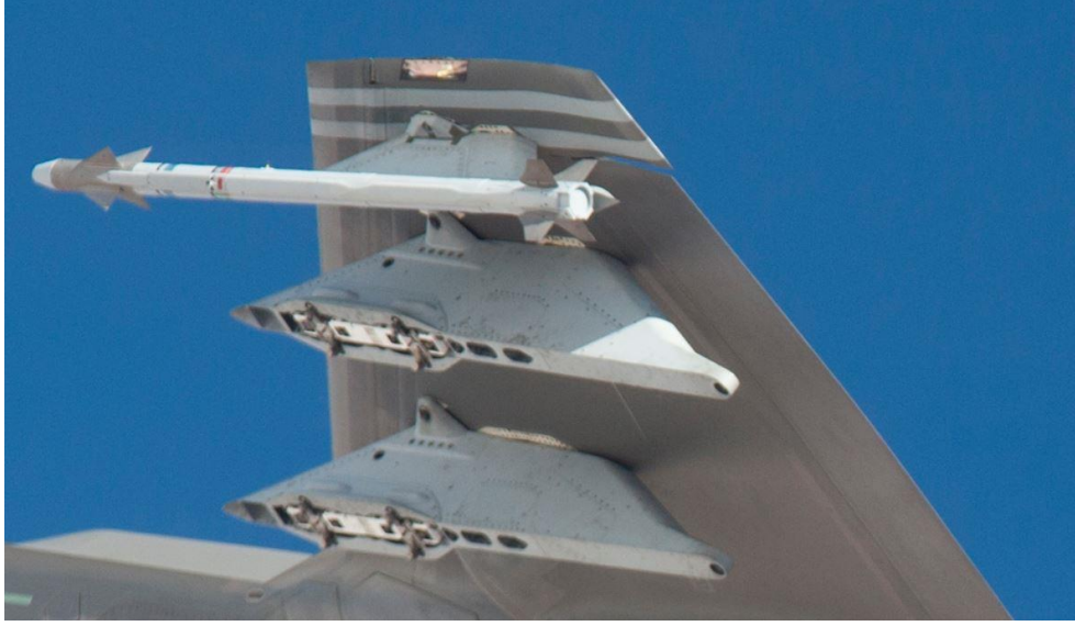
Şekil 7. F-35 Hava-Yer Yük Pylon'u Uçak Üstü Bağlantı Gösterimi [12]
