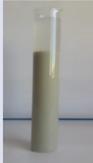
Resim 4. Sedimentasyon yöntemiyle MMT'in saflaştırılması
