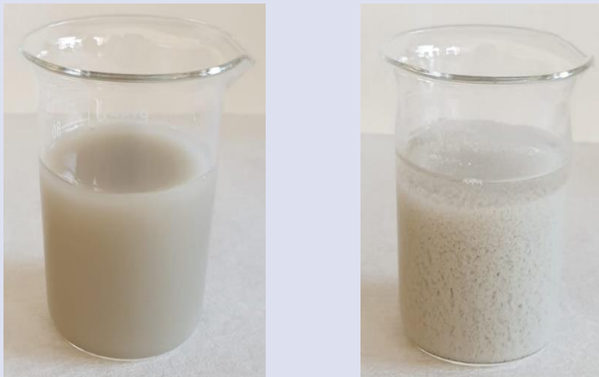
Resim 6. MMT'in dodesil trimetil amonyum klorür ile organofilik montmorillonitin (OMMT) hazırlanma işlemi
