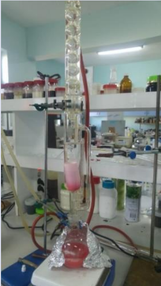
Resim 3. Sumağın değişik çözücülerle Soxhlet düzeneğinde özütlenmesi
