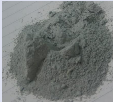
Resim 1. Montmorillonit (MMT) mineralinin tabakalı yapısı ve öğütülmüş hali (Fu, 2019) Figure 1. Layered structure and ground form of montmorillonite (MMT) mineral (Fu, 2019)
