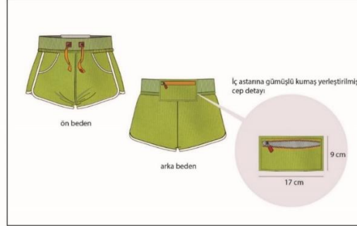
Şekil 20. Tasarım Önerisi -4, Bisiklet ya da Koşu Sporunda Kullanılabilecek Alt Giyim. (Özgün Tasarım Hande Bilvar)
