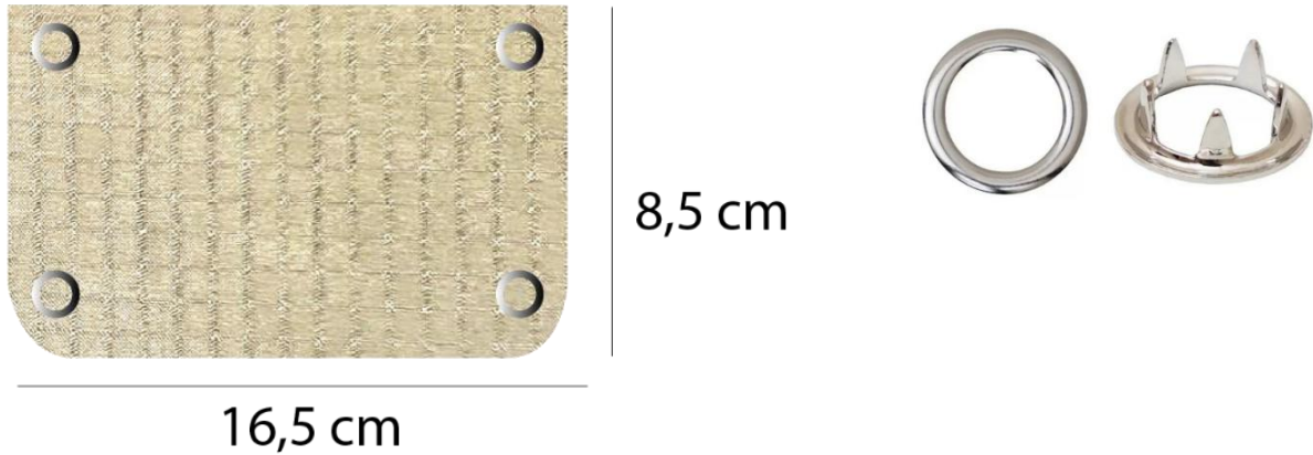
Şekil 13. Cep içine Aplike Edilecek Gümüş Kaplamalı Kumaşın Çizimi ve Örnek Kliket Görseli (9,5 mm bebe kliket) (Tasarım Hande Bilvar, 2024)
