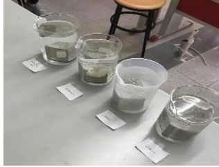
Şekil 23. Sıvaların suda bekletilmesi
