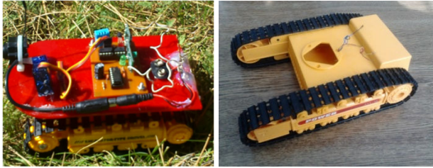
Şekil 7. Palet hareket sistemi (Pallet movement system)
