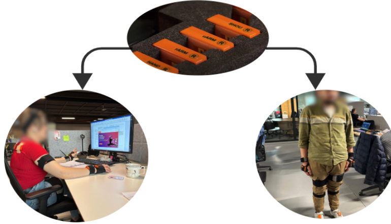
Şekil 1. Xsens Teknolojisinin Kullanıcı Üzerinde Yerleşimi: IMU Sensörleri, Oturma Ve Ayakta Duruş Pozisyonlar
