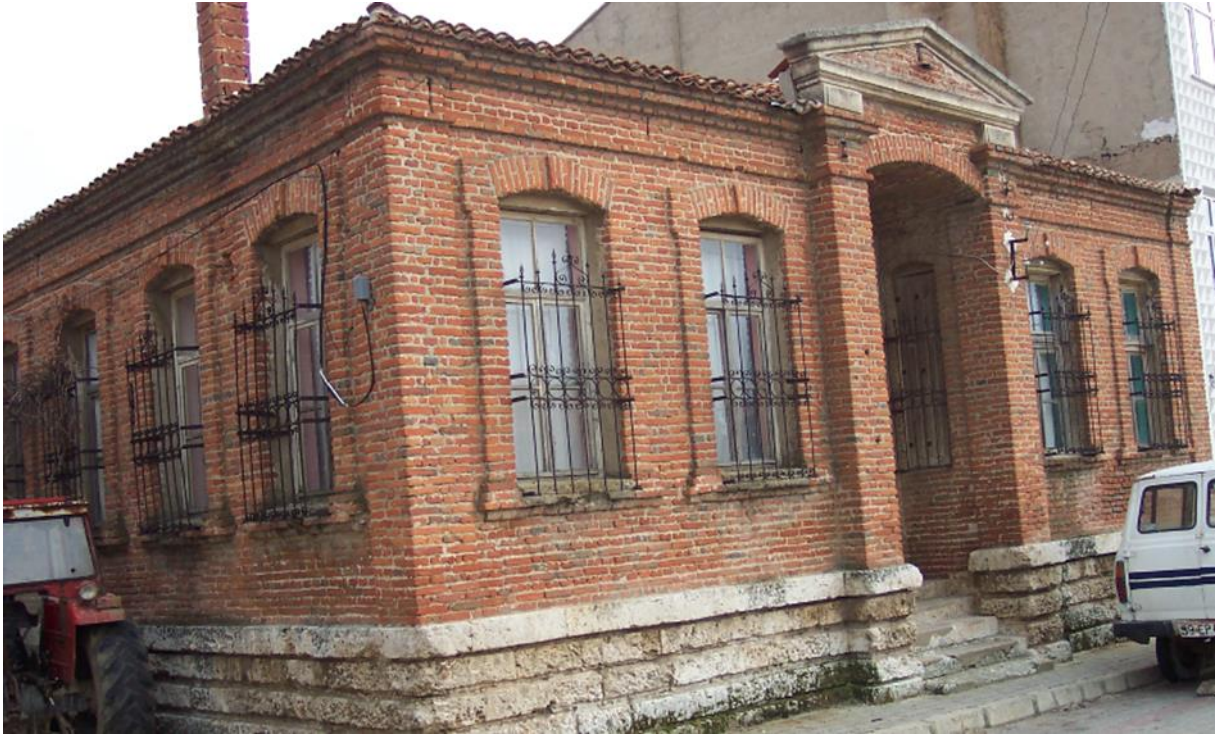
Şekil 8. Kırklareli Geleneksel Konutlarında Tuğla Malzemenin Kullanımı
