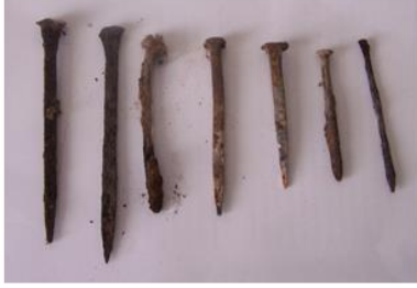
Ahşap iskelet sistemde birleşimi sağlayan çiviler
