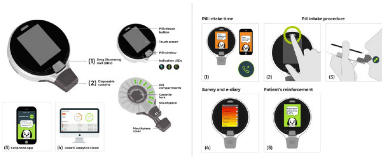
Resim 7. ReX Sistemi Bileşenleri ve Kullanımı (Sht-richman vd., 2018)
