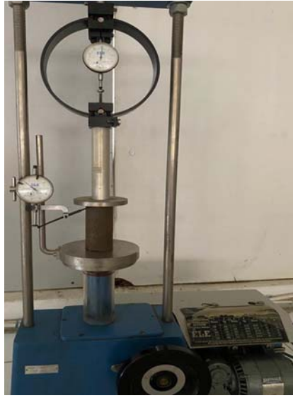
Şekil 5. Serbest basınç aleti ve kil numunesi
