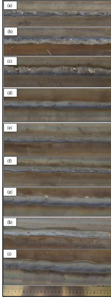
Şekil 7. Kaynak dikişlerinin farklı parametrelerde elde edilen makro görüntüleri a) A1 b) A2 c) A3 d) B1 e) B2 f) B3 g) C1 h) C2 ı) C3
