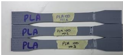
Şekil 5. %100 doluluk oranına sahip numunelerin çekme testi sonrası görünümü (The appearance of samples with 100% fill rate after the tensile test)
