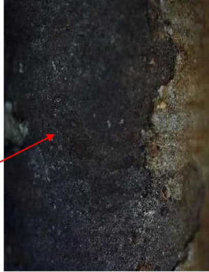
Resim 7. Hava Giriş Üst Muhafazası Sızdırmazlık Contası
