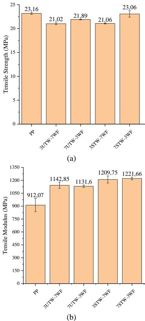
**Figure 1.** a) Tensile strength and b) Tensile modulus
