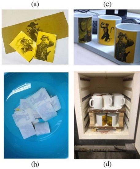
Görsel 19. (a) Baskının kurummasının ardından lak atılmış çıkartma kağıdı (b) Çıkartma kağıdının transfer aşaması için suda beklemesi (c) Çıkartma lastiği yardımıyla hava ve su bırakmadan yüzeye aktarılması (d) Ürünün fırın ortamına pişirim için yerleştirilmesi (Burcu Keskin Uygulama)
