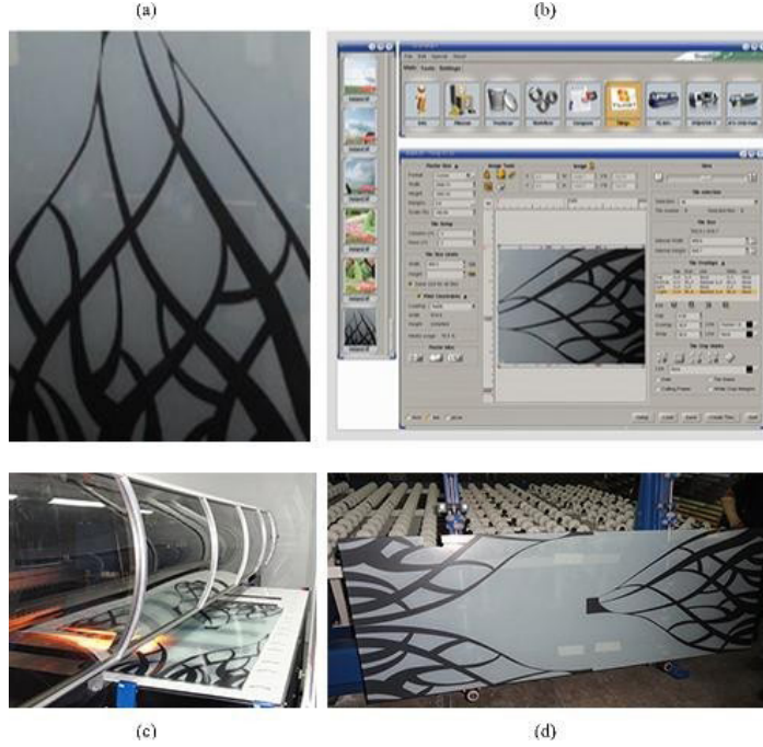
Görsel 4. (a) Tasarım (b) Görsel düzenleme yazılımıyla tasarımı baskıya hazırlama. (c) Baskı İşlemi ve UV Kurutma (d) Baskının son hali (Burcu Keskin Uygulama)
