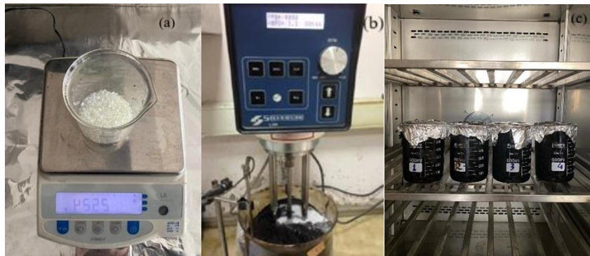
Şekil 1. a: Katkı maddesi oranı tayini, b: karıştırma işlemi, c: kürlenme işlemi Figure 1. a: Additive ratio determination, b: mixing process, c: curing process
