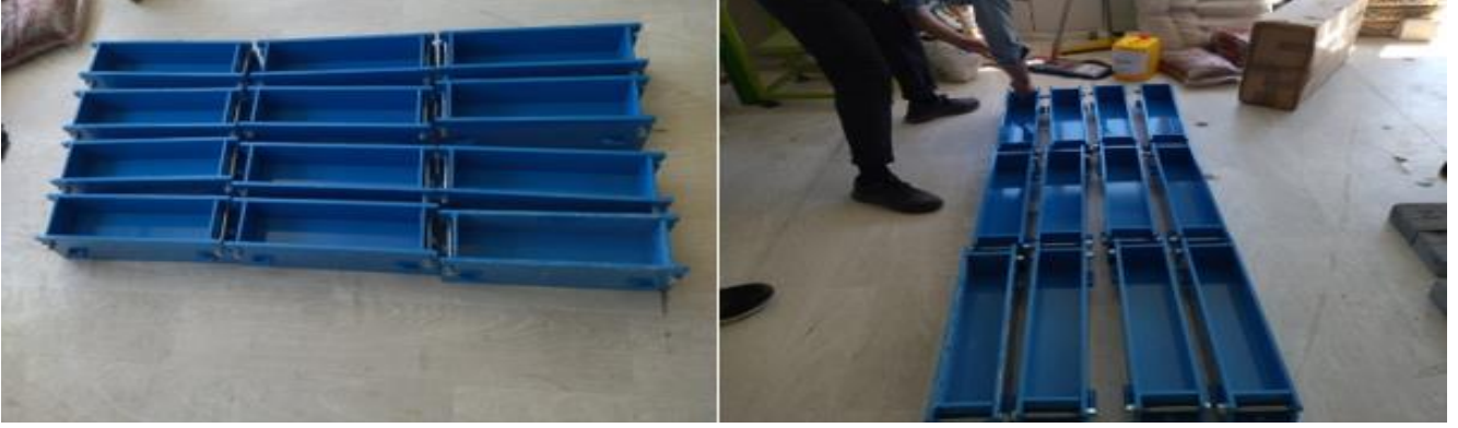
Şekil 4. Hafif beton dökümü öncesinde kiriş numune kalıplarının hazırlanması
