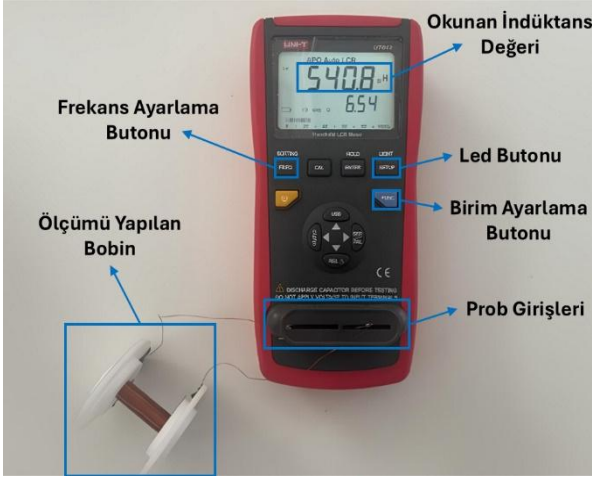
Şekil 3. Örnek bir bobinin ölçümü.
