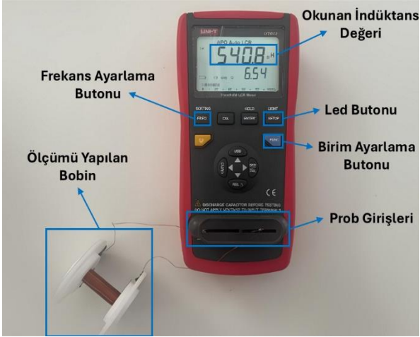
Şekil 3. Örnek bir bobinin ölçümü.
