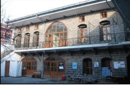
Resim 13. Saçak ve gezemeğin betonarme olarak değiştirildiği bir ev örneği
