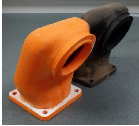
Şekil 4: Orijinal turbo şarj dirseği ve 3 boyutlu yazıcıdan alınan çıktı (turuncu).
