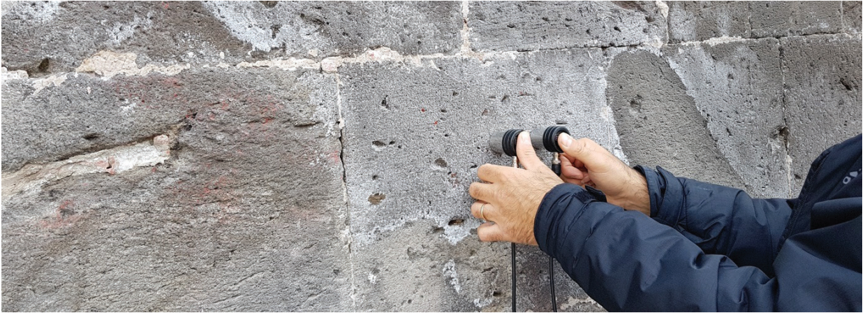
Şekil 6. Tarihi eserlerde gerçekleştirilen P-dalga hızı ölçümlerinden bir görünüm
