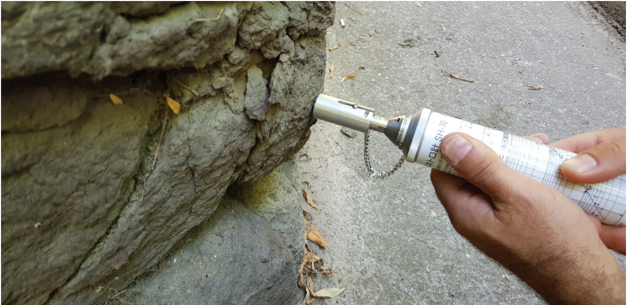
Şekil 5. İğne Penetrometresi'nin bozunmuş ignimbirit blokları üzerinde uygulanması.
