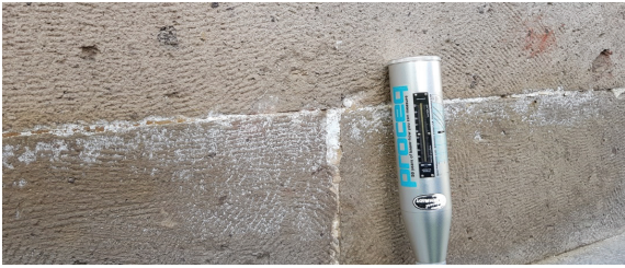
Şekil 3. Tarihi eserler üzerinde kullanılan L-tipi Schmidt Çekici’nden bir görünüm.
