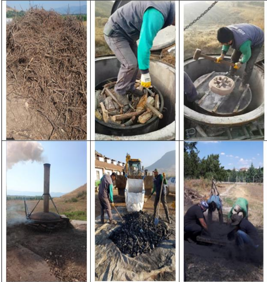
Şekil 1. Budama atığından geleneksel yavaş piroliz yöntemiyle biyokömür elde etme aşamaları
