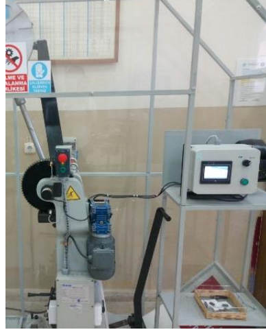
Şekil 2. Darbe Deneyi Test Düzenegi (Impact Test Set-up)
