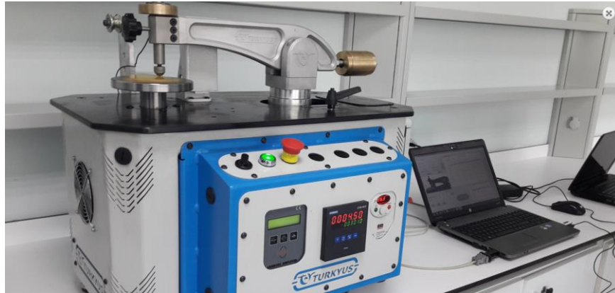
Şekil 3. Pin-On Disk Aşınma Test Cihazı (Pin-On Disc Setup)
