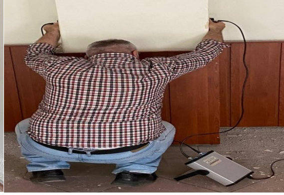
Şekil 4. Ultrasonik ses hızı ölçümü yapılması
