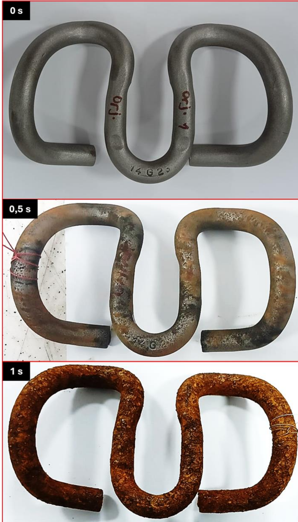
Şekil 5. Gergi kıskacında yüzey korozyonunun saatlik gelişim aşamaları
