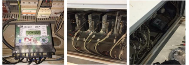
Şekil 9. CNC makinasına entegre elektronik sayaç. Figure 9. Electronic counter integrated into the CNC machine.
