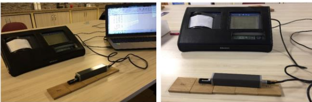
Şekil 7. Mitutoyo SurfTest SJ-301 Yüzey pürüzlülüğü ölçüm cihazı Figure 7. Surface roughness measuring device
