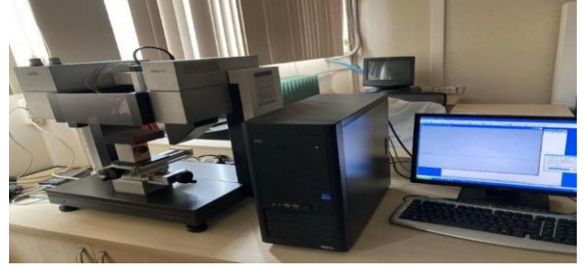
Şekil 8. Temas açısı ölçüm cihazı. Figure 8. Contact angle measuring device.
