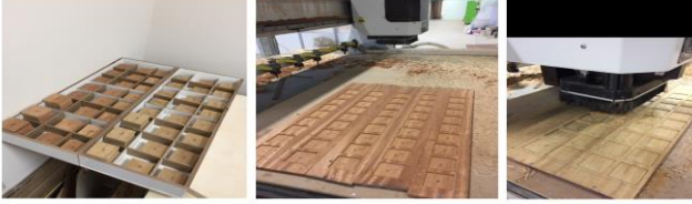
Şekil 6. Deney numunelerinin CNC makinasında hazırlanması. Figure 6. Preparation of test samples on CNC machine.
