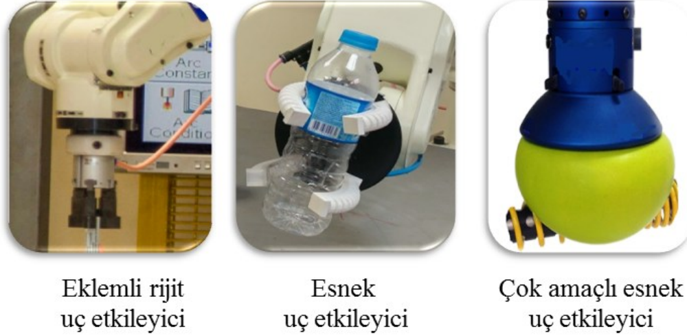
Şekil 9. Endüstriyel robotlarda esnek robotik uç etkileyicilerle aktif kavrama sistemi
