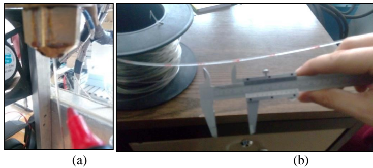
Şekil 8: Filament üretim hızı ölçümü a) İşaretleme b) Ölçüm
