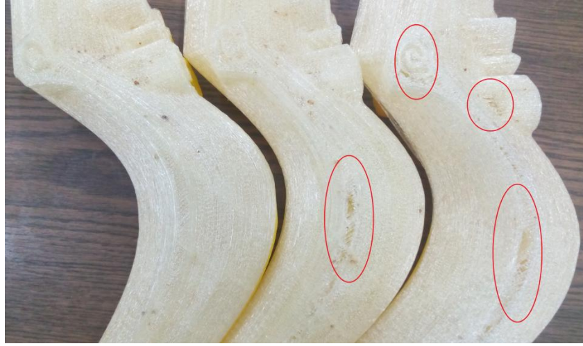
(a) (b) (c) Şekil 14: Sehpa ayağı baskı numuneleri hataları (a) 40 mm/s yazdırma hızda (b) 50 mm/s yazdırma hızda (c) 60 mm/s hızda
