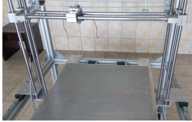
Şekil 4: Üç boyutlu yazıcı tabla ve hareket eksenleri montajlı
