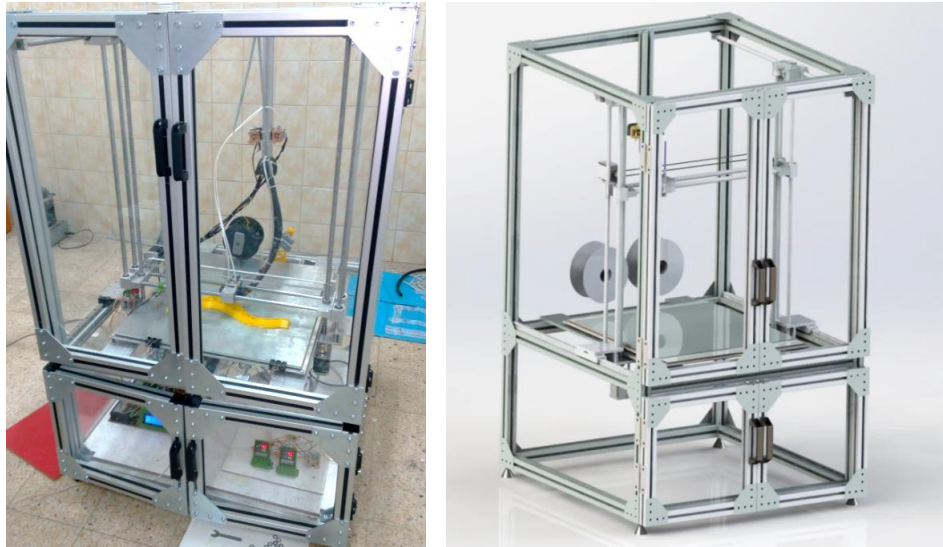
Şekil 1: Endüstriyel boyutlu çift başlı kartezyen tipi üç boyutlu yazıcı prototip ve modeli
