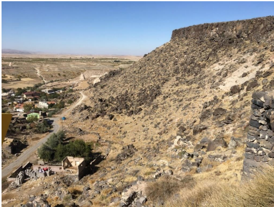
Şekil 13: Daha önceden düşen kaya bloklarının yuvarlanma zonu üzerindeki dağılımı
