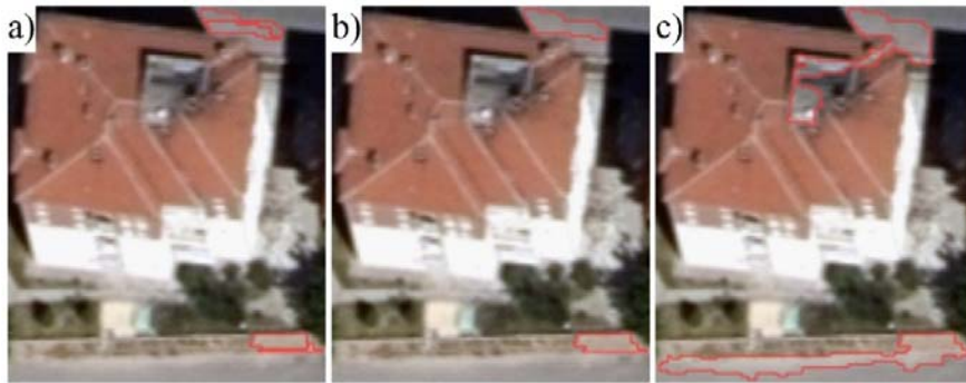
Şekil 2. Multiresolution segmentasyon parametrelerinden ölçek parametresinin değişimine bağlı olarak obje sınırlarının nasıl farklılaştığı: a) 10, b) 20, c) 50
