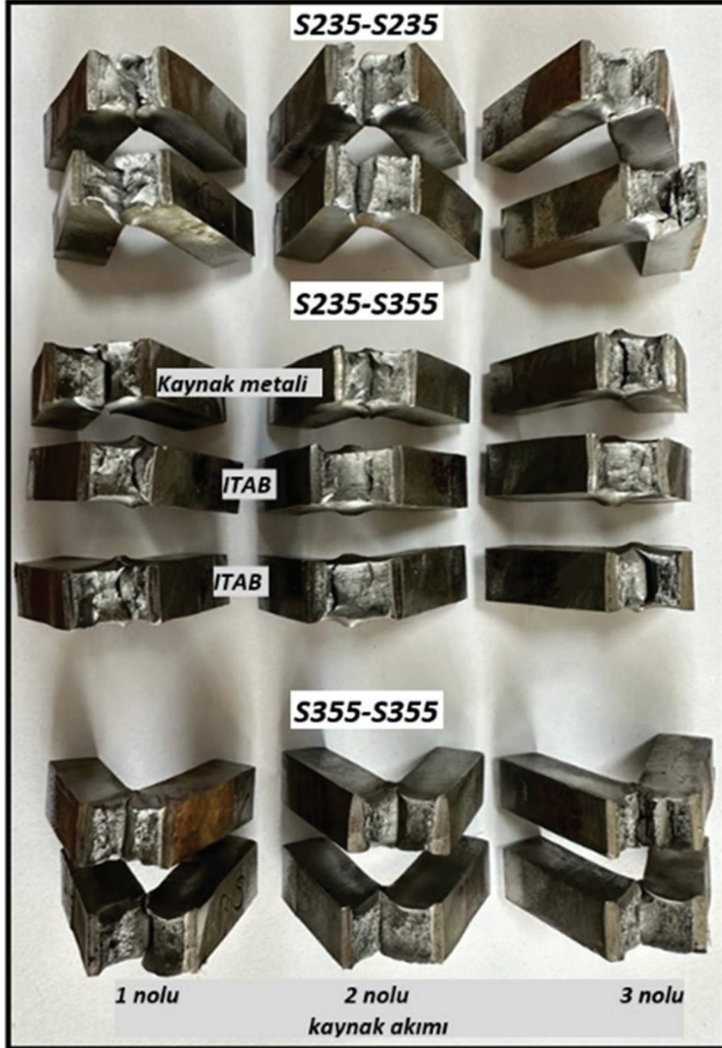
Şekil 7. Çentik darbe testi sonrası elde edilen numune görüntüleri.
