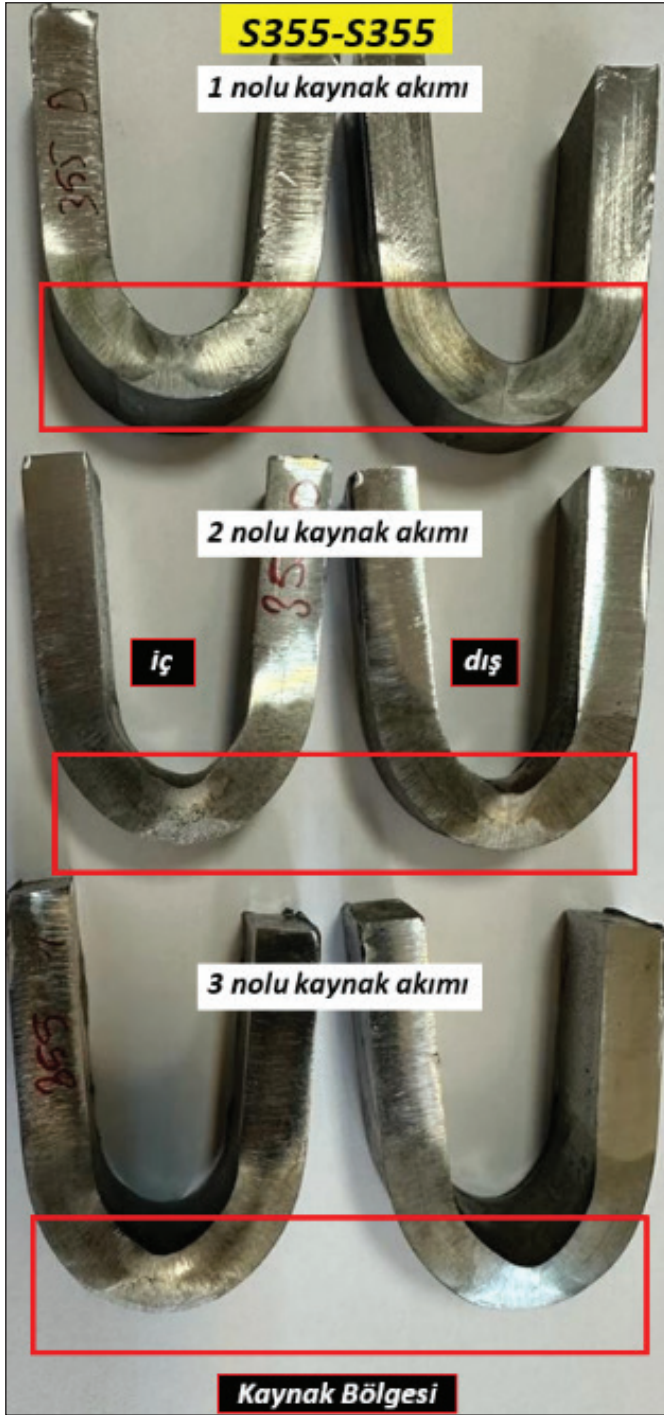
Şekil 10. S355-S355 numunelerin eğme testleri sonrası görünümleri.
