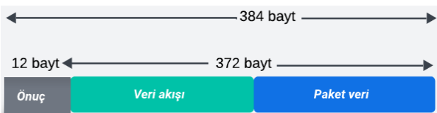
Şekil 12. MOST150 protokolü çerçeve yapısı
