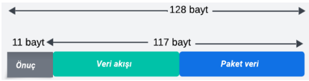
Şekil 11. MOST50 protokolü çerçeve yapısı
