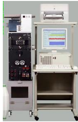
Resim 12. Ket 80V/C düzgünsüzlük test cihazı [25]
