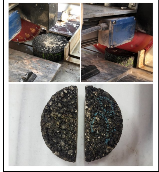
Şekil 3. Yarım daire numunelerinin hazırlanması ve nihai numuneler.
