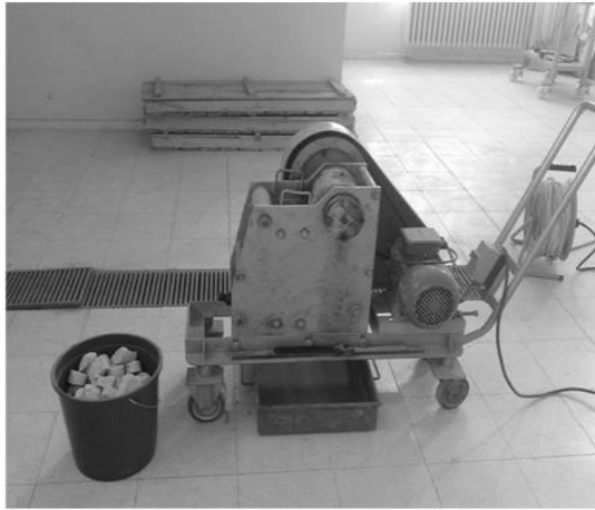
Şekil 5. Çeneli kırıcıdan geçirilen malzeme
