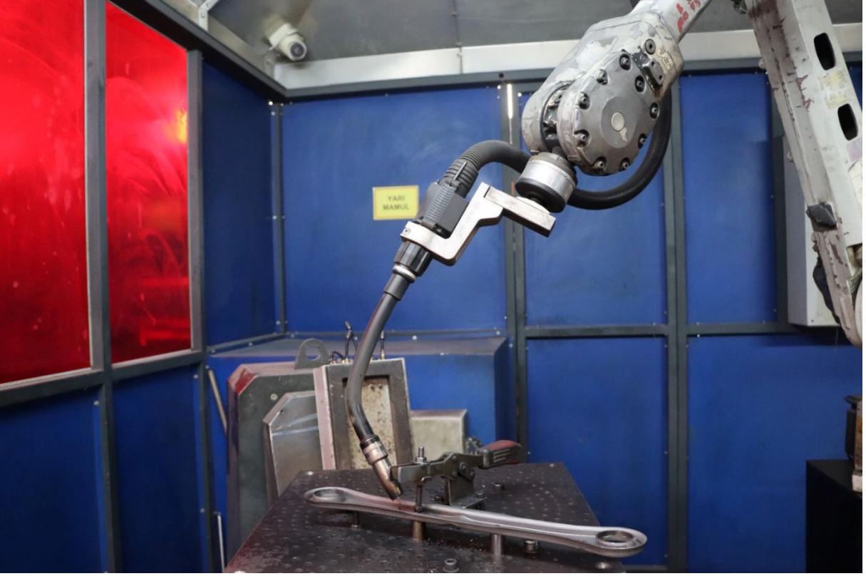
Şekil 1. Kameranın tanımlanmış kaynak kanalına göre konumlandırılması
