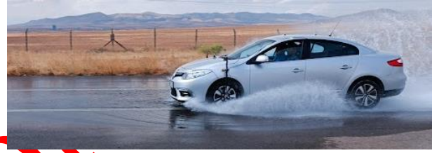
Şekil 8. Yönlü desenli lastik aquaplaning testi (Directional pattern tire aquaplaning test)
