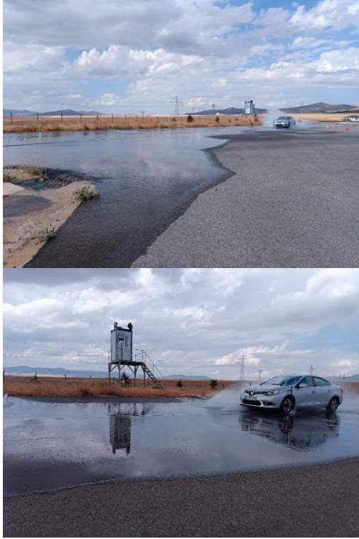
Şekil 9. Aşınmış lastik aquaplaning testleri (Worn tyre aquaplaning tests)
