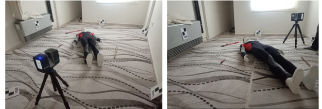
Şekil 6. YLT ile veri toplama (ayak tarafı).
