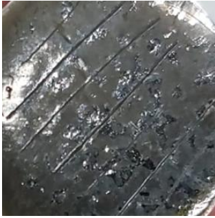
Şekil 6. Mikrokapsül içeren epoksi ile kaplanan numune üzerine atılmış manuel çizikler (Numune yüzeyinde SEM analizi için altın/paladyum kaplama bulunmaktadır)
