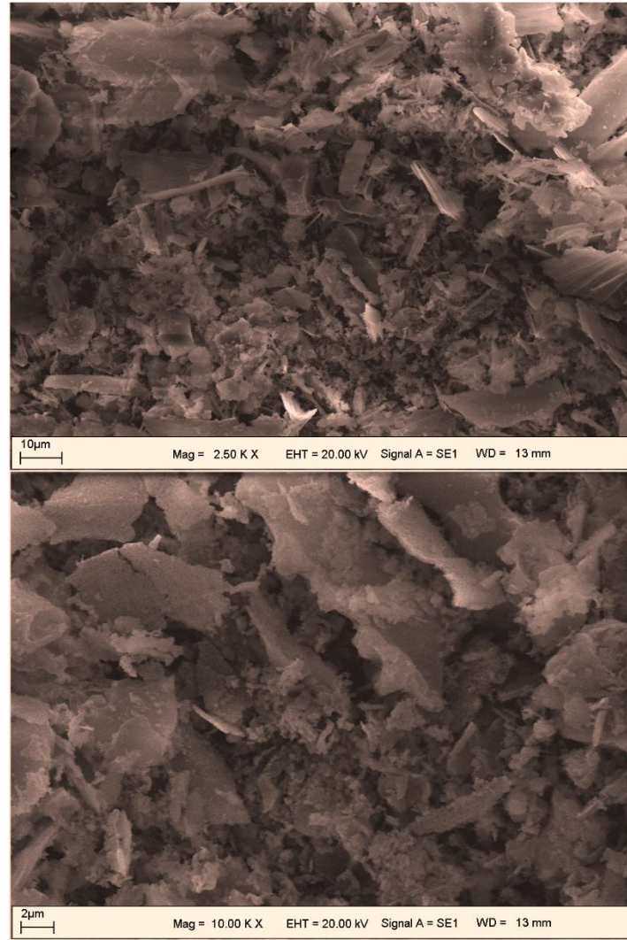
Şekil 2. Kanyaş otu külünün taramalı elektron mikroskop (SEM) görüntüsü
