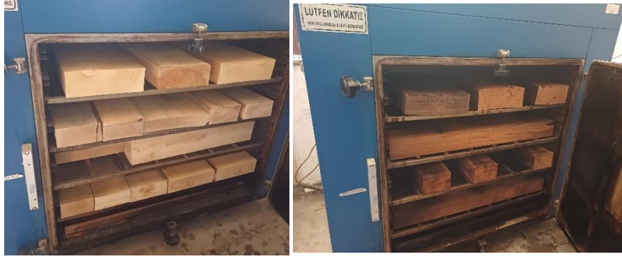
Resim 1. Isıl işlem fırınında istifleme (Stacking in heat treatment furnace)
