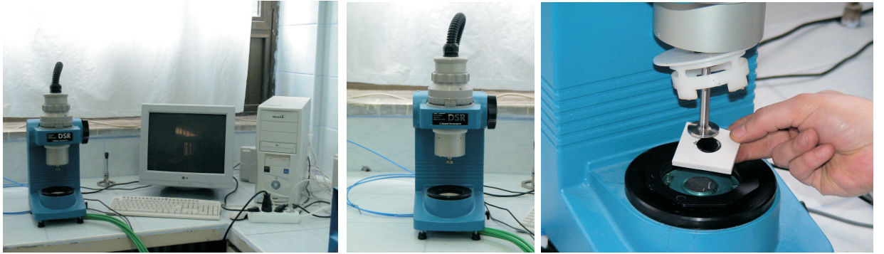
Şekil 2. DSR Deney Düzenegi ve Numunenin Plaklar Arasına Yerleştirilmesi
