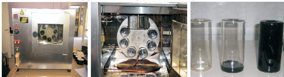
Şekil 1. Dönel İnce Film Etüvü ve Deney Öncesi ve Sonrasında Şişelerin Durumu
