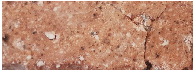
Şekil 10. Taş bünyenin dağılması, Öz Kapadokya, R1 1040°C Sırlı krem renkli taş bünye
