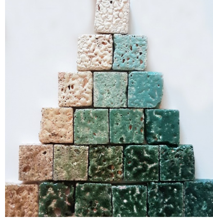
R1ÜD2 reçetesi ile üç faz diyagram, sırlanmış vişne renkli taş, 1040°C
