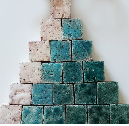
R1ÜD1 reçetesi ile üç faz diyagram, sırlanmış krem renkli taş, 1040°C
