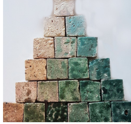
R1ÜD2 reçetesi ile üç faz diyagram, sırlanmış krem renkli taş, 1040°C
