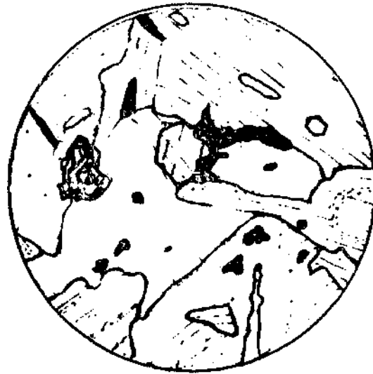
Fig. 10 - Hornblendegabbro Bytownit, grüne und braune Hornblende, sekundär Magnetit, Apatit, Sphen, Differenzierungsmineral Chlorit. 10 ×
