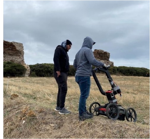
Resim 4: Kalede RTK-GPS kullanılarak gerçekleştirilen yeraltı görüntüleme çalışmaları
