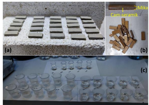
Şekil 2. Mika plakalar arasına yerleştirilen cam-seramiklerin fırınlama öncesi (a) ve sonrası (b) görüntüleri, kimyasal süreç (c)
