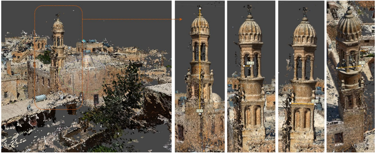
Şekil 4. Dijital model üzerinden ölçümlerin elde edilebilmesi (Yazar tarafından oluşturulmuştur.)
