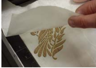
Şekil 2.8. Dolap kapağının lazer ile oyulması işlemi – 8
