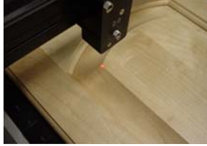
Şekil 2.2. Dolap kapağının lazer ile oyulması işlemi – 2
