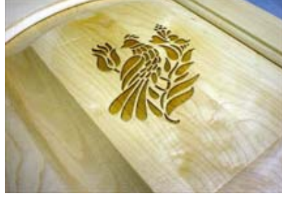
Şekil 2.5. Dolap kapağının lazer ile oyulması işlemi -5
