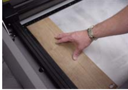
Şekil 2.6. Dolap kapağının lazer ile oyulması işlemi - 6
