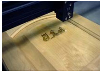
Şekil 2.4. Dolap kapağının lazer ile oyulması işlemi – 4
