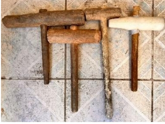
Fotoğraf 6-7: Tokmaklar ve çekiçler (Ahmet Özcan atölyesi)
