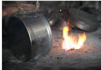
Fotoğraf 13: Bakracın kalaylama işlemi
