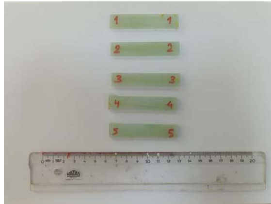
Şekil 7. Üretimi gerçekleştirilen fiber takviyeli deney numuneleri
